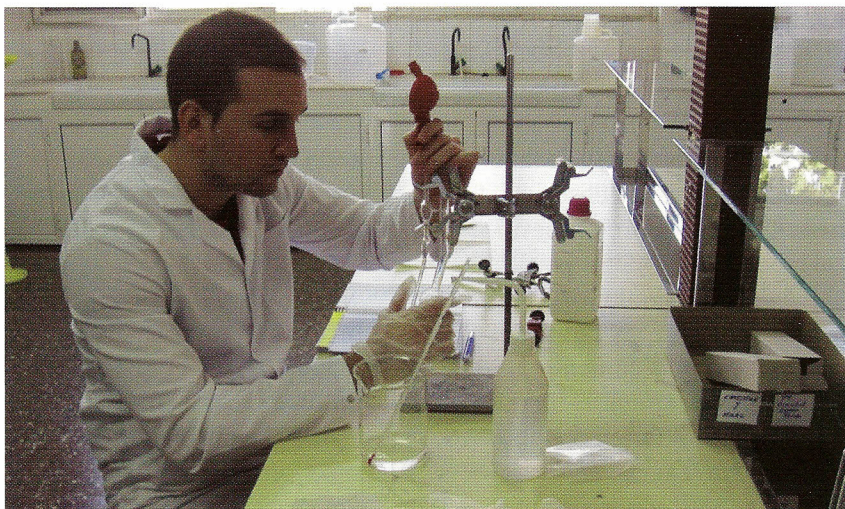
Figura 16. Alumne realitzant una mesura de viscositat amb Cannon-Fenske sense ulleres i només amb un guant.
